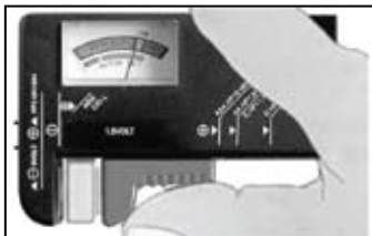
Prova di una pila bottone da 1,5 V
