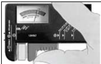
Connexion des piles boutons de 1,5 V
