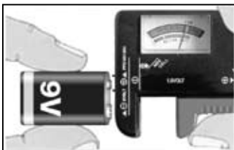
Prova di una pila da 9 V
