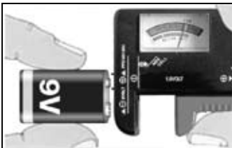
Anschließen der 9-V-Batterie
